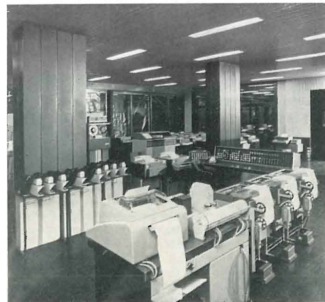
Fig. 1. — Vista d'insieme delle apparecchiature elettroniche DS (Data Switcher) impiegate nel Centro Elettronico di Ritrasmissione Automatica di Messaggio (CERAM) della Italcable.
