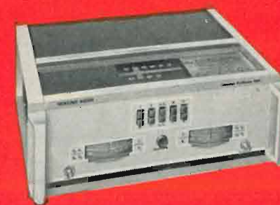
Fig. 10 - Ponte universale per misure di resistenze capacità induttanze RF
