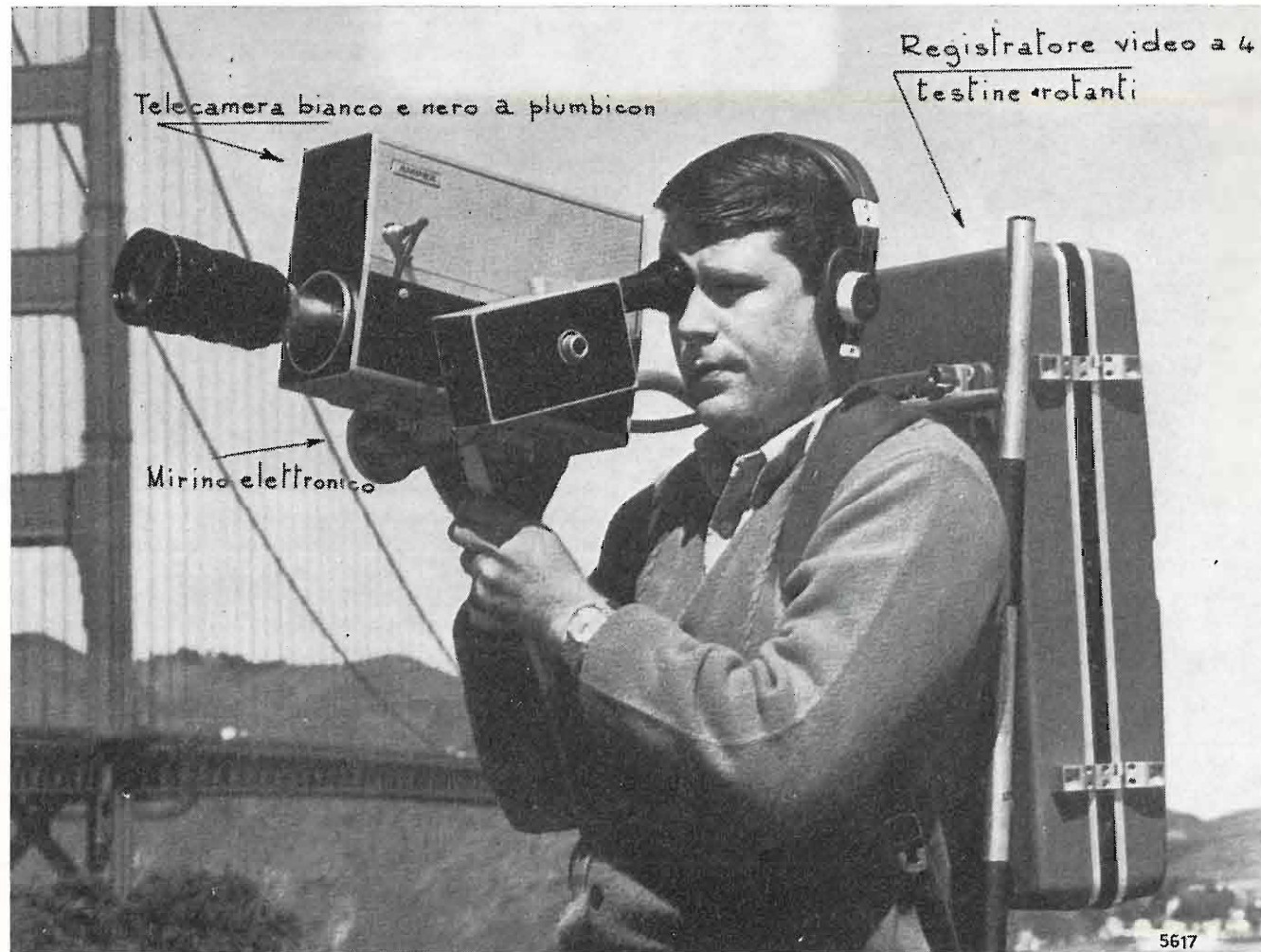
Fig. 14. — Registratore video portatile professionale con telecamera.
