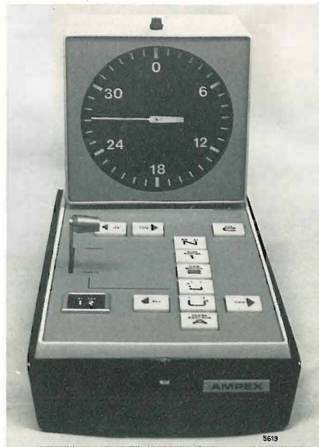
Fig. 10. — Pannello di comando del rallentatore di immagini TV.
